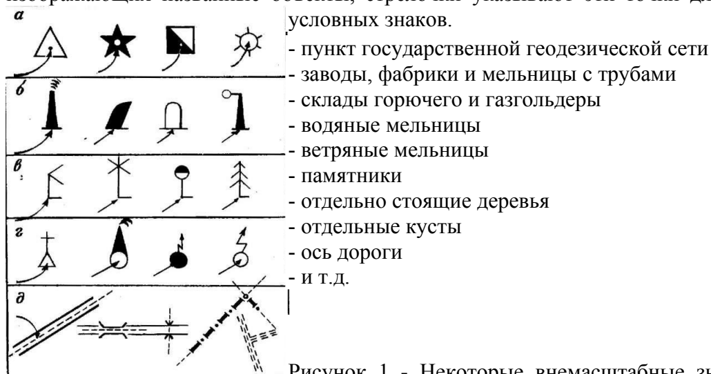
Рисунок 1 - Некоторые внесмасштабные знаки. Стрелочки указывают те точки знаков, которые соответствуют центрам самих изображаемых объектов (главная точка условного знака)
