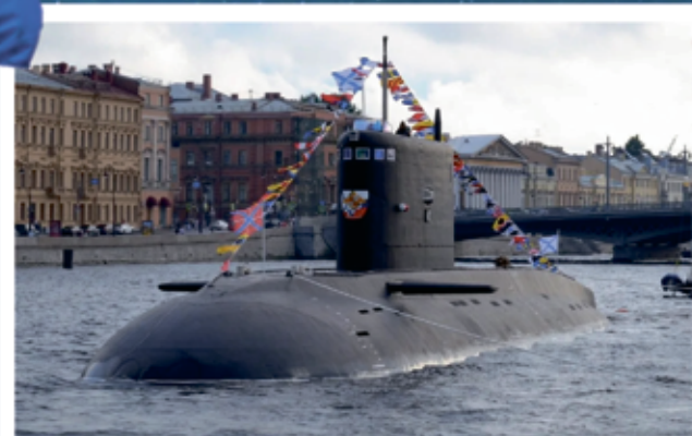
«Варшавянка» (проект 636) – являются модернизированным вариантом экспортной подводной лодки проекта 877ЭКМ «Палтус». Предназначены для скрытного патрулирования и борьбы с целями, обладают низким шумом и современным вооружением, эффективны в любых морских операциях
